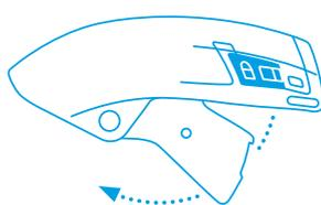
Gire la palanca hacia fuera del mango y abra la cubierta de la hoja.
