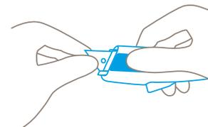
Mueva el desplazador completamente hacia delante. Gire el mango para que la cubierta transparente de la hoja quede mirando hacia arriba.
