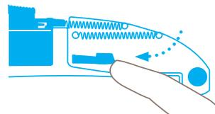
Libere el gargador de la hoja **presionando hacia abajo y empujando hacia delante**, como se indica.
