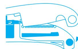
Finalmente, pliegue la **mitad superior del mango hacia abajo** hasta que se coloque en su sitio. Por favor, compruebe la retracción de la hoja!
