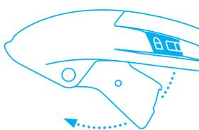
Gire la palanca hacia fuera del mango y abra la cubierta de la hoja.
