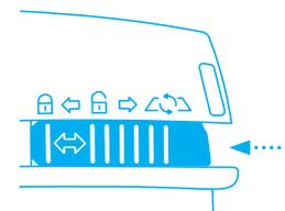
Por último vuelva a empujar la palanca **dentro del mango** y ajuste el seguro 3 en 1 en la posición de bloquear o desbloquear.
