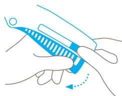
A continuación, gire la palanca completamente **fuera del mango** y abra la cubierta de la hoja.
